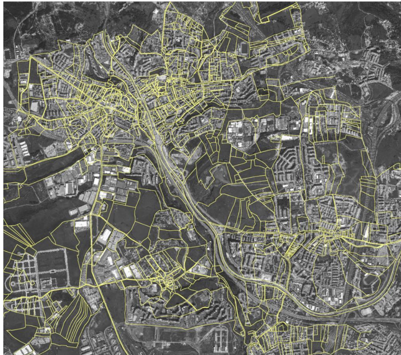
Reconstituição do parcelário relativo à década de 1940, com base nas fotografias aéreas do IGP/DGT (ano 1944) e folhas cadastrais do IGP/DGT, sobreposta a ortofoto de 2015.
